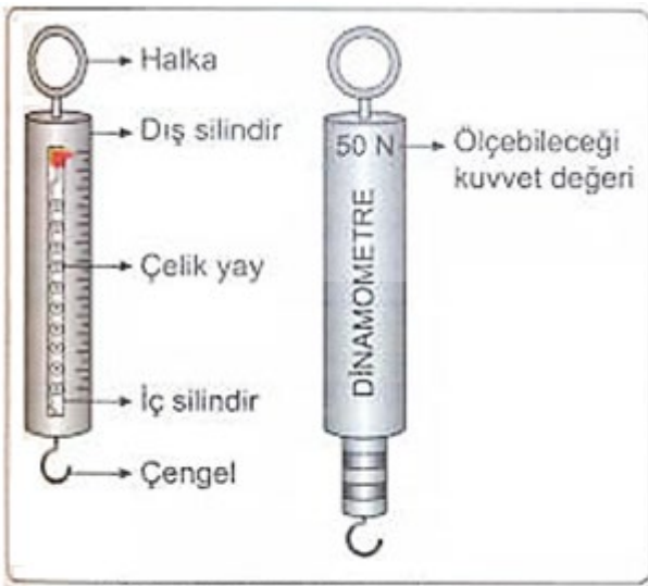
Dinamometrenin iç ve dış yapısı
